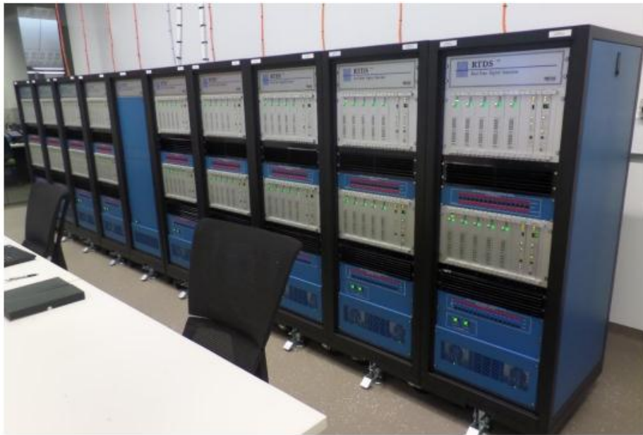
شکل ۱۱-۱۲: سیستم RTDS مستقر در دانشگاه New South Wales
